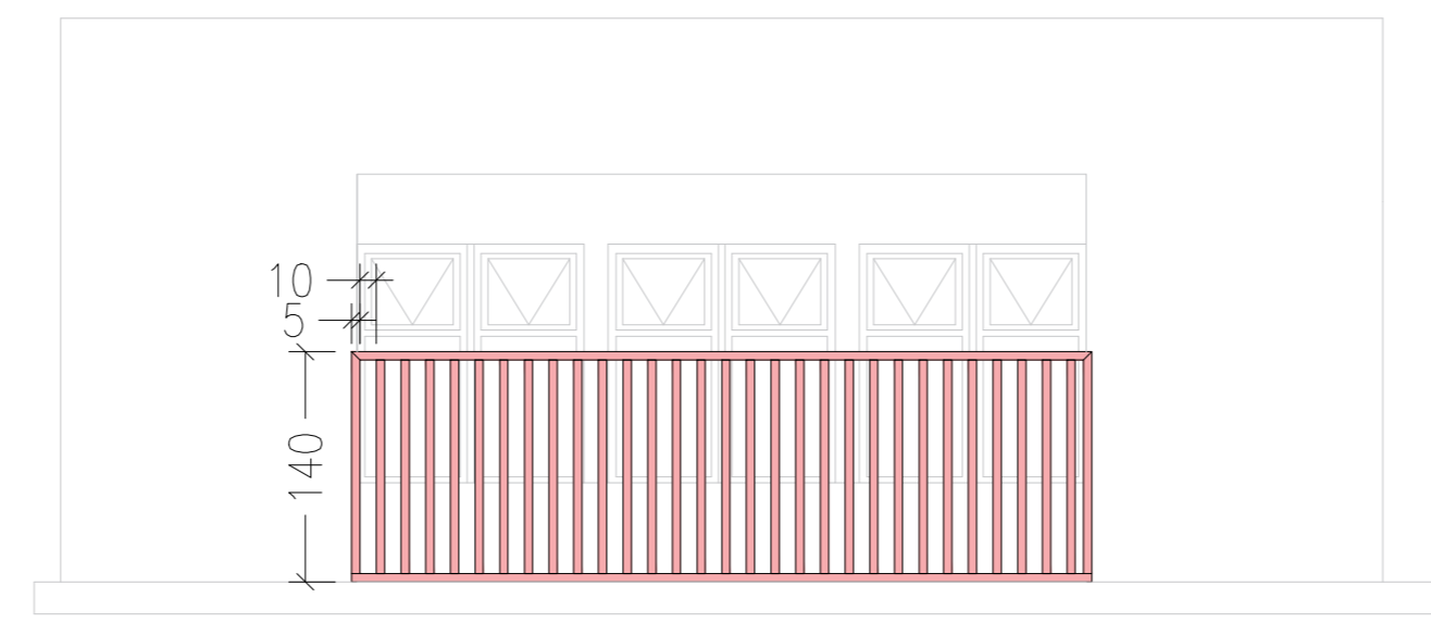
DETALLE DE REJAS PROTECCIÓN PABELLÓN 5
